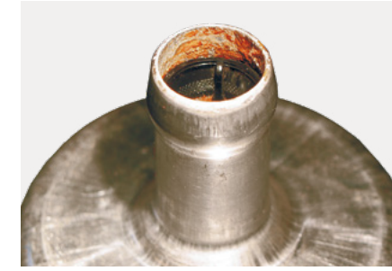
Paslanmış pompa girişi (su hasarı)
