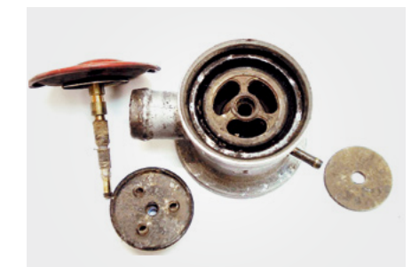
Pnömatik sekonder hava supabı: Kondensat nedeniyle hasar
