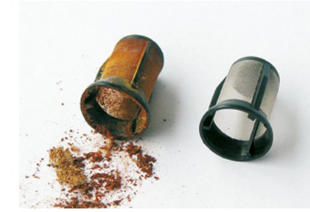
Tıkanmış süzgeç filtresi ve yeni durum
