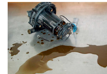
Sekonder hava pompasında kondensat
